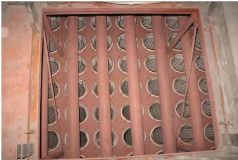
Contrôles et travaux de nettoyage sur les filtres à manches
